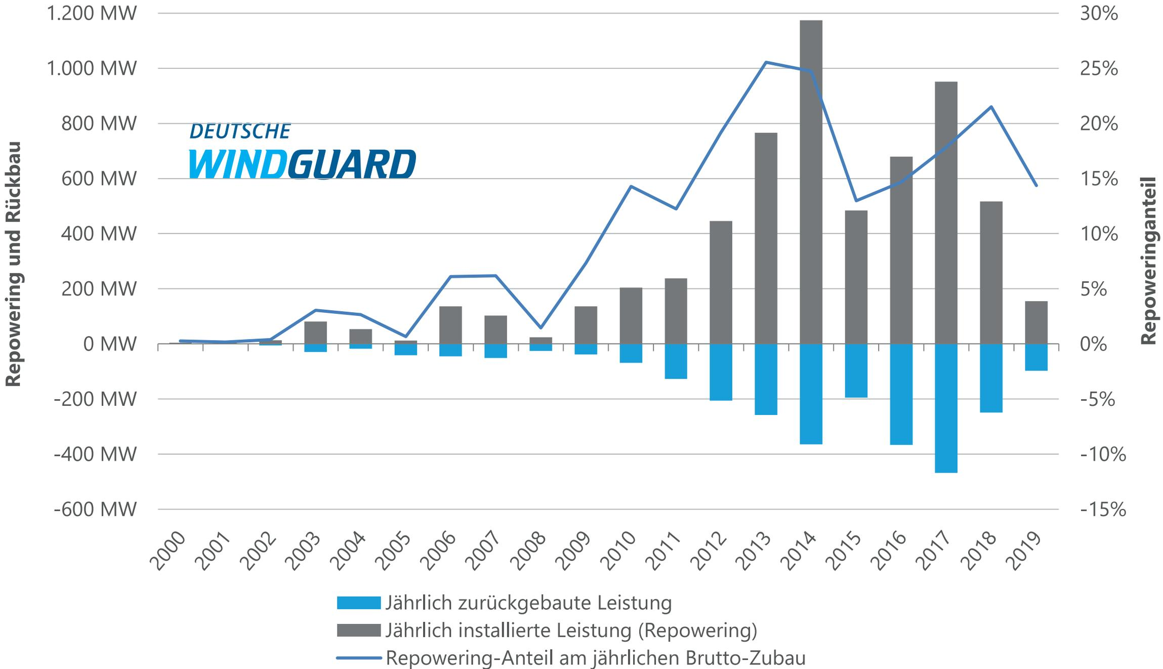
Entwicklung der jährlich und anteilig im Rahmen von Repowering-Projekten installierten sowie der abgebauten Leistung
